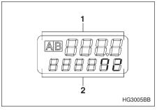
1) Trip meter 2) Odometer
