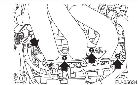
25) Remove the EGR pipe securing bolt.
