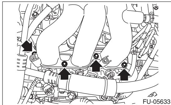
4) Install the EGR pipe securing bolt.
