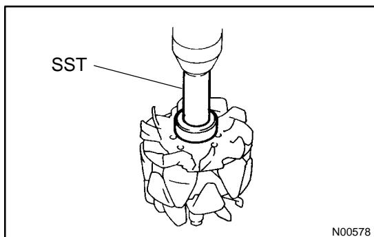
(d) Using SST and a press, press in a new bearing.
