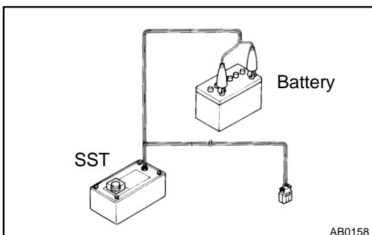
(d) Check functioning of the SST (See step 1-(a) on page [RS-17](#) ).
