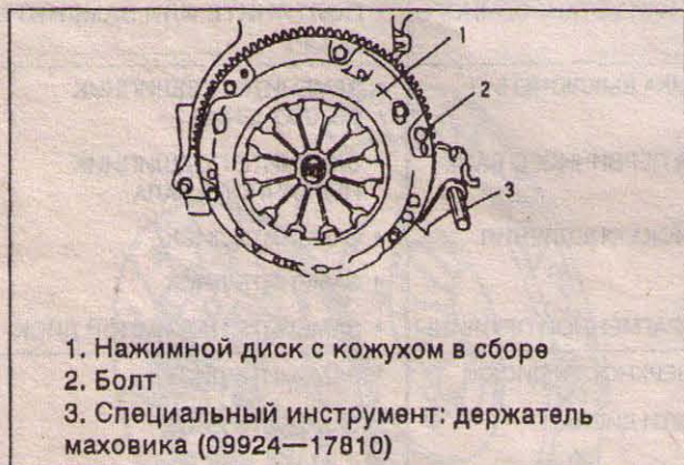
Рис. 2В—7 РАЗБОРКА НАЖИМНОГО ДИСКА С КОЖУХОМ В СБОРЕ
