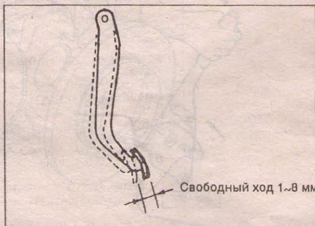
Рис. 5-18 ПРОВЕРКА СВОБОДНОГО ХОДА ТОРМОЗНОЙ ПЕДАЛИ
