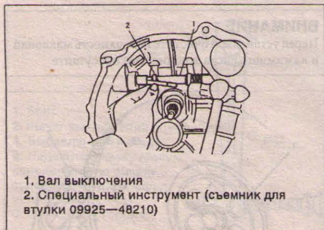
Рис. 2В—9 СНЯТИЕ ВТУЛКИ № 2
