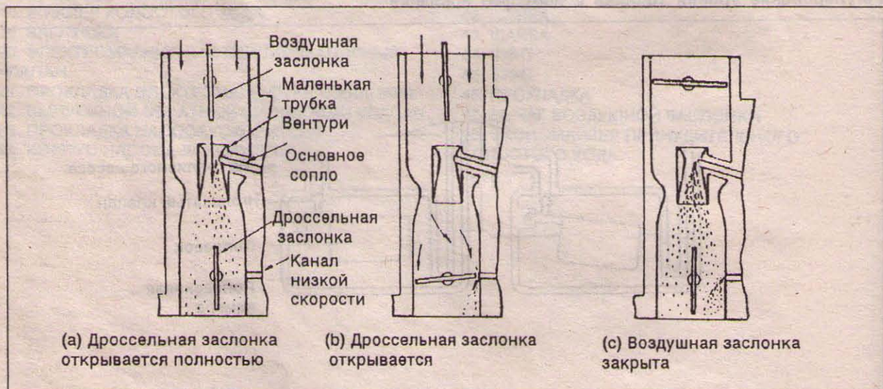
Рис.1D—10 РЕГУЛИРОВАНИЕ КОЛИЧЕСТВА ТОПЛИВА И ВОЗДУХА
