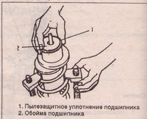
Рис. 4D—8 УСТАНОВКА УПОРНОГО ПОДШИПНИКА
