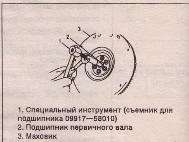
Рис. 2В—8 СНЯТИЕ ПОДШИПНИКА ПЕРВИЧНОГО ВАЛА
