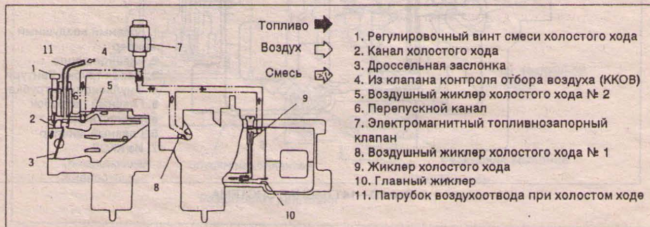
Рис.1D—12 СИСТЕМА ХОЛОСТОГО ХОДА
