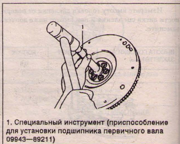
Рис. 2В—15 УСТАНОВКА ПОДШИПНИКА ПЕРВИЧНОГО ВАЛА
